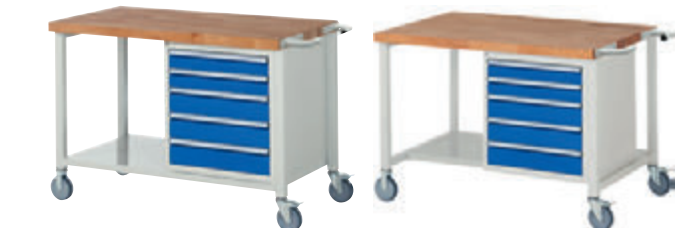
2 x Schublade 2x150 mm (Traglast 50 kg) Buche-Massiv-Ablageboden, Stärke 25 mm - Tiefe 545 mm - Fachhöhe 420/595 mm
