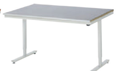
Stahlblechbelag-Platte Oberfläche mit 1,5 mm starkem, feuerverzinkten Stahlblechbelag, Stärke 25 mm, Umbug vorne in L-Form
