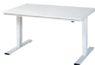
EGB-Melamin-Platte Ober- und Unterseite mit einer leitfähigen, lichtgrauen Melaminharz direktbeschichtung (nach DIN 68765). Volumenleitfähige Mittel-lage. Normaler Abriebwiderstand, bedingte Kratz- und Stoßfestigkeit. Stärke 28 mm
