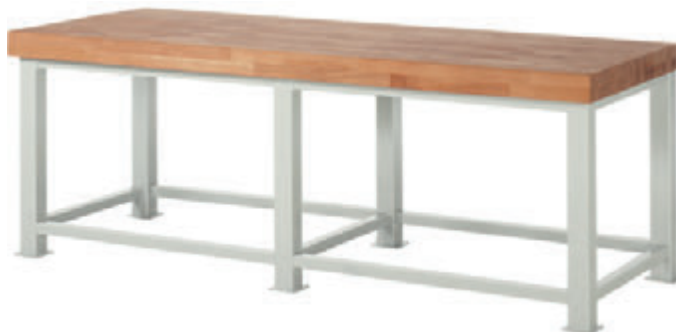
Buche-Massiv-Arbeitsplatte Stärke 100 mm Flächentraglast max. 4.500 kg
