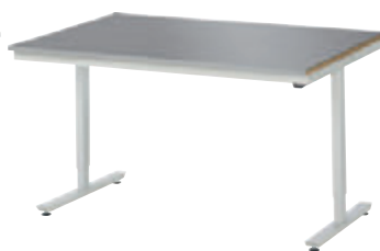
Edelstahlblech-Platte Oberfläche mit 1,5 mm starkem Edelstahlbelag (NIROSTA®). Edelstahl nach X5CrNi18-10, Werkstoffnummer 1.4301 gem. DIN EN 17441/10088-2. Stärke 25 mm, Umbug vorne in L-Form.
