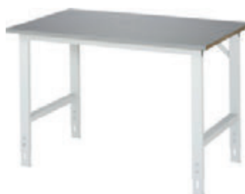
Edelstahlblech-Platte Oberfläche mit 1,5 mm starkem Edelstahlbelag (NIROSTA®). Edelstahl nach X5CrNi18-10, Werkstoffnummer 1.4301 gem. DIN EN 17441/10088-2. Stärke 25 mm, Umbug vorne in L-Form.
