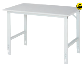
EGB-Melamin-Platte Ober- und Unterseite mit einer leitfähigen, lichtgrauen Melaminharz direktbeschichtung (nach DIN 68765). Volumenleitfähige Mittel-lage. Normaler Abriebwiderstand, bedingte Kratz- und Stoßfestigkeit. Stärke 28 mm
